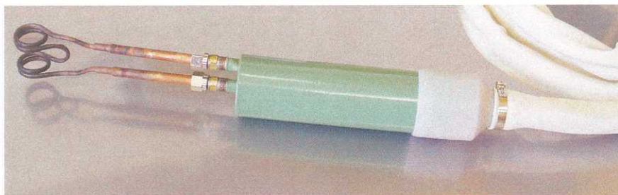
Zdjęcie transformatora z kablami i wzbudnikiem
